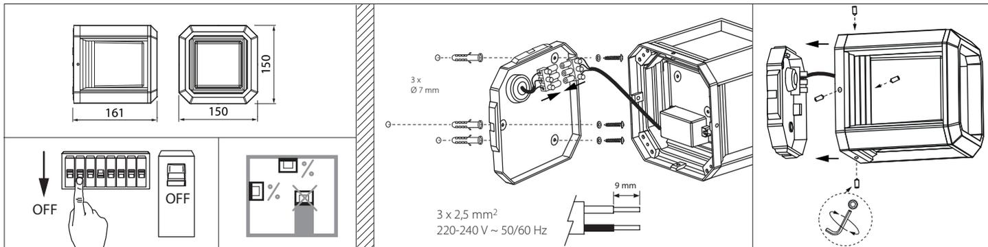
Valaisimen saa asentaa vain sähköalan ammattilainen. Käytä ainoastaan syöttöjännitettä ja taajuutta joka on merkitty valaisimeen. Kytke virta pois päältä ennen asennusta tai huoltoa. Tämä asennusohje on säilytettävä ja sen on oltava käytössä asennuksessa ja huollossa. Valaisimen valonlähde ei ole käyttäjän vaihdettavissa. Vaihda tilalle uusi valaisin, jos valonlähde rikkoutuu.
