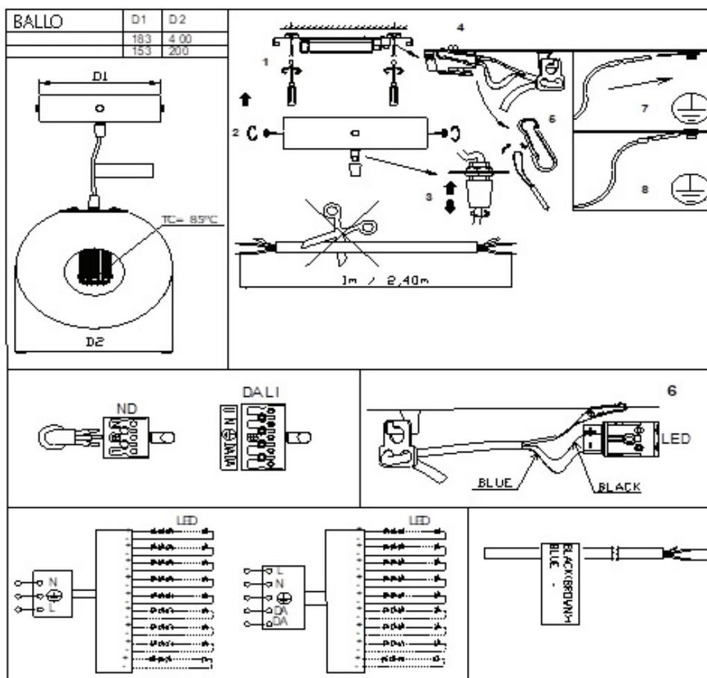
Valaisimen saa asentaa vain sähköalan ammatilainen. Käytä ainostaan syöttöjänitettä ja taajuutta joka on merkity valaisimeen/liitäntälaitteeseen. Kytke virta pois päältä ennen asennusta tai huoltoa. Tämä asennusohje on säilytettävä ja sen on oltava käytössä asennuksessa ja huollossa. Tämän valaisimen valonlähde ei ole vaihdettavissa. Kun valonlähde rikkoutuu, koko valaisin on poistettava käytöstä.
