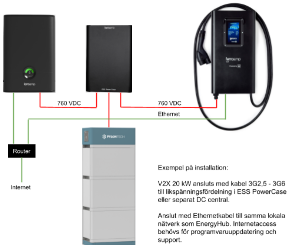
Figur - Exempel på installation till Ferroamp EnergyHub system med ESS PowerCase och batteri.
