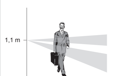
Rys. 3: Miejsce montażu czujników ruchu
