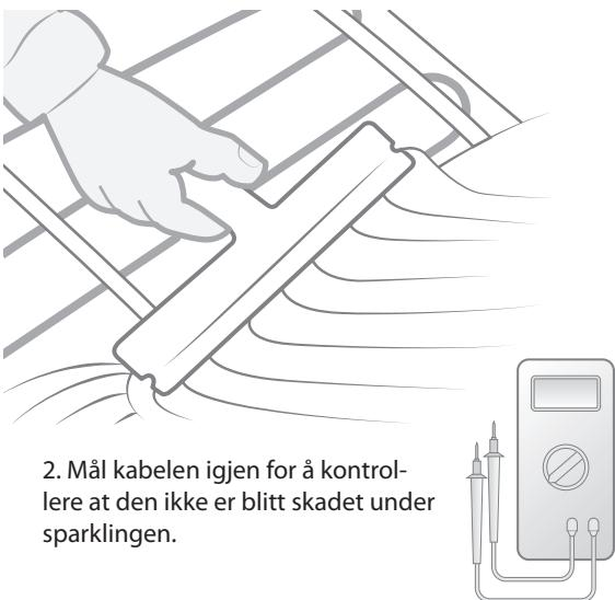
2. Mål kabelen igjen for å kontrollere at den ikke er blitt skadet under sparklingen.
